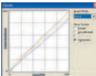
Колориметрические графики для Samsung SyncMaster 510MP. Практически идеальные прямые. Есть небольшое отклонение от диагонали
